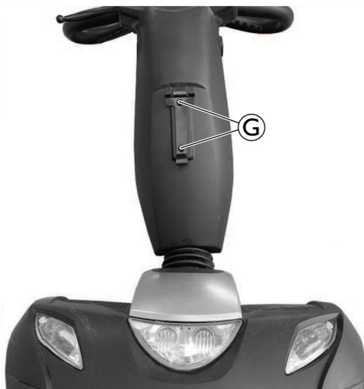
Desserrez les vis © pour déposer le support de panier avant.
