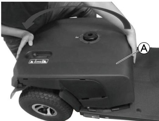
Placez une main à l'avant et l'autre à l'arrière du carénage ①.
