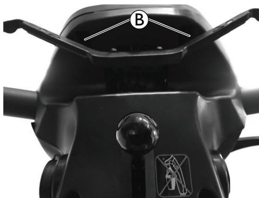
Retirez les vis **(B)** au-dessous de la console de commande.
