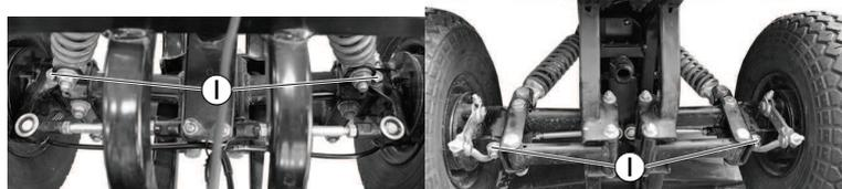
Retirez les vis, les écrous et les rondelles ① pour déconnecter les essieux avant ② des supports d'essieu avant ①.
