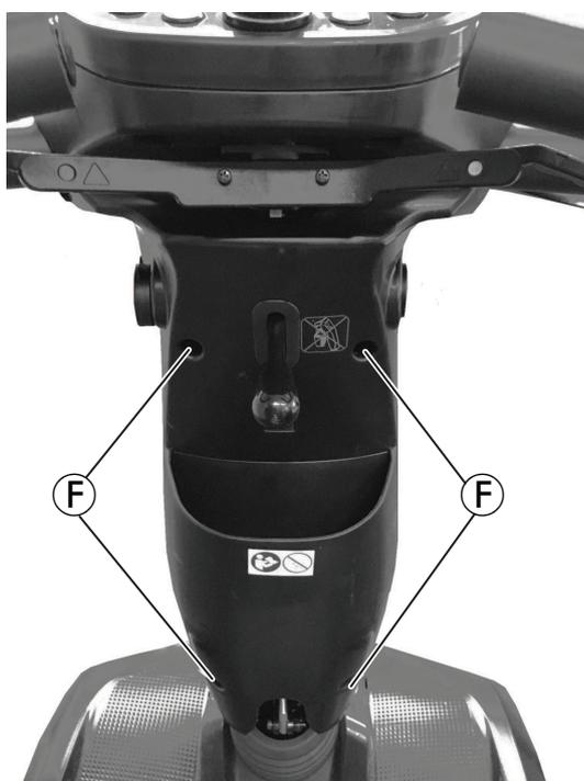
Retirez les vis ⑥ pour déposer le carénage arrière de la colonne de direction.
