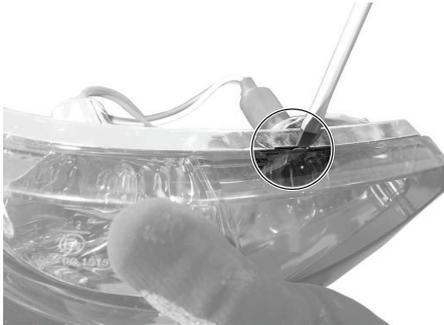
Utilisez un tournevis plat pour retirer les crochets plastiques des creux.
