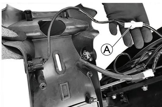
Débranchez le câble du cylindre **A** du faisceau électrique.
