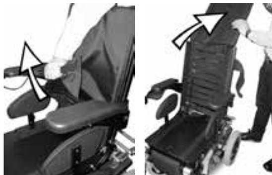
Um die Rückenhöhe zu verändern müssen zuerst die Deckel (A) der Rückenlehnenrohre gelöst werden.
